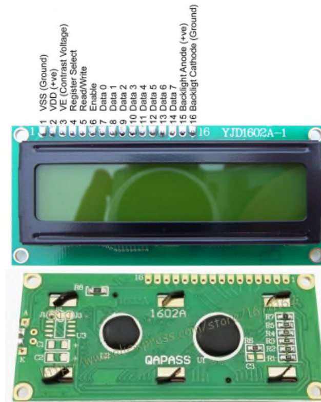
Gambar 2.6. Bagian depan (atas) dan bagian belakang (bawah) modul panel LCD
