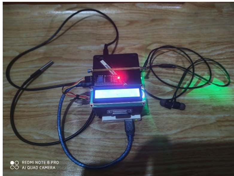
Gambar 3.6. Implementasi purwa rupa sistem termometer dengan output suara
