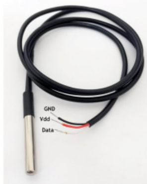
Gambar 3.3. Bentuk fisik sensor DS18B20 [6]
