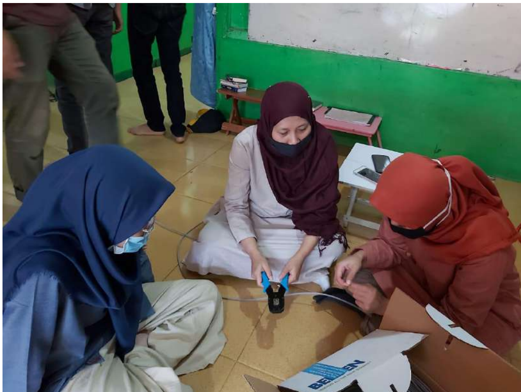
Pemasangan RJ45 pada kabel UTP
