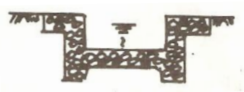
Gambar 2.1 Bentuk penampang/potongan melintang selokan.
