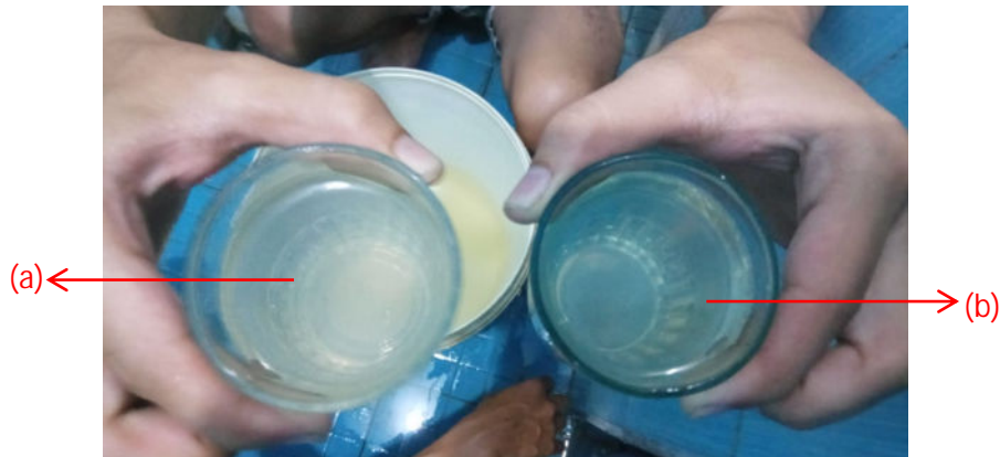
Gambar 4.5 Hasil Pengujian Filter (a) Air sebelum di filter (b) Air setelah di filter
