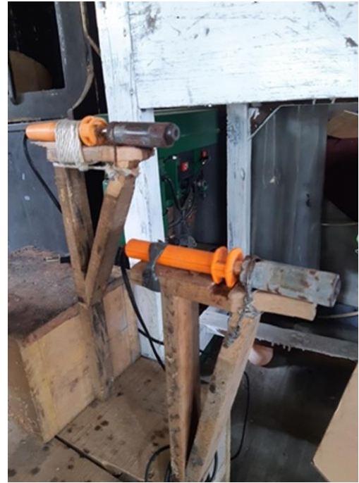
Dua dari beberapa alat yang digunakan pengrajin, untuk bending dan perapihan/ finishing (dok. Penulis)
