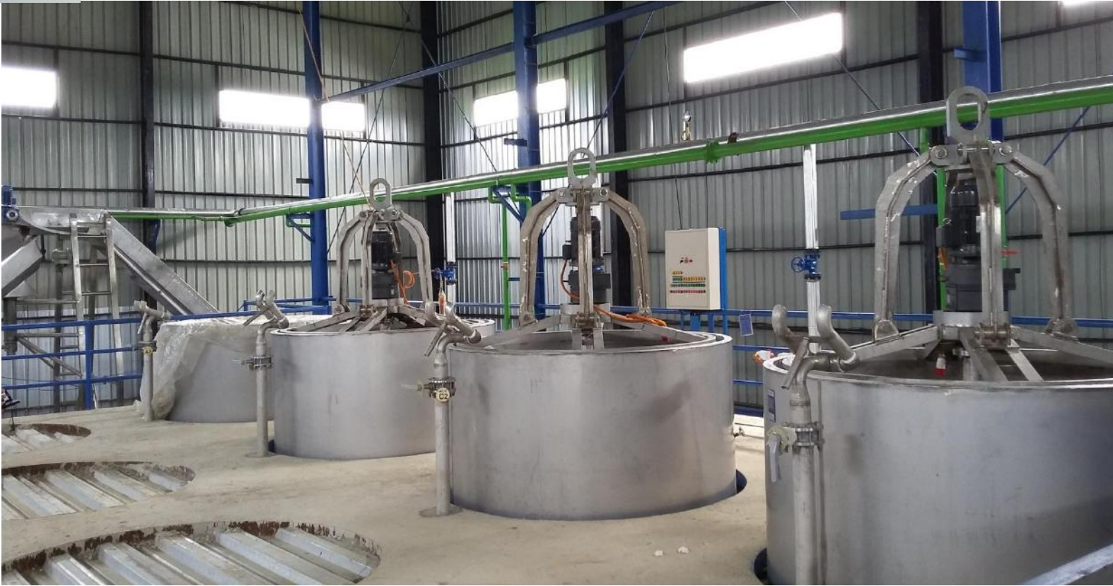
Tangki alkalisasi untuk gracilaria dengan agitator
