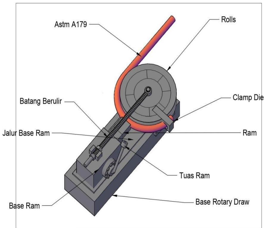
Rancangan alat bantu *rotary draw* terdiri dari *base rotary draw* yang merupakan bagian dasar yang berfungsi *base plate* kemudian *clamp die*, *rolls*, *base ram* ditempatkan di bagian atas dari *base rotary draw*. *Tuas ram*, batang berulir ditempatkan di *base ram*.
