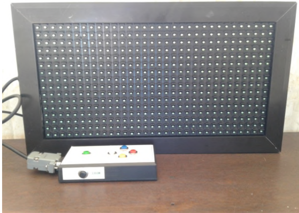
Gambar 4.1. Hasil implementasi sistem jeda waktu iqamah
