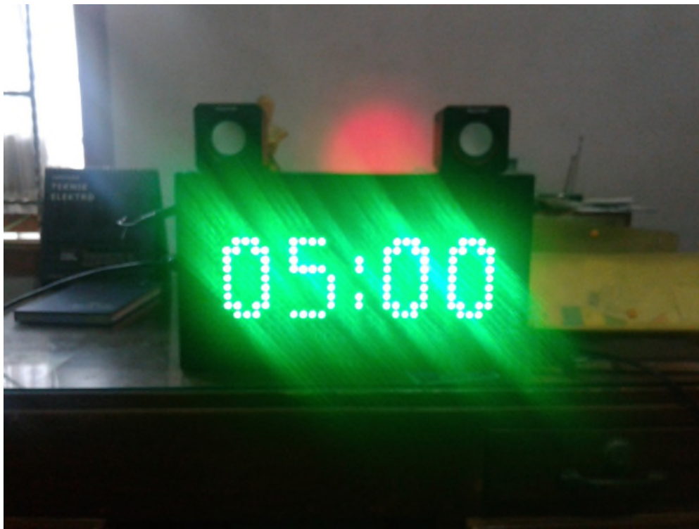
Gambar 4.4.Sistem jeda waktu iqamah dengan speaker eksternal
