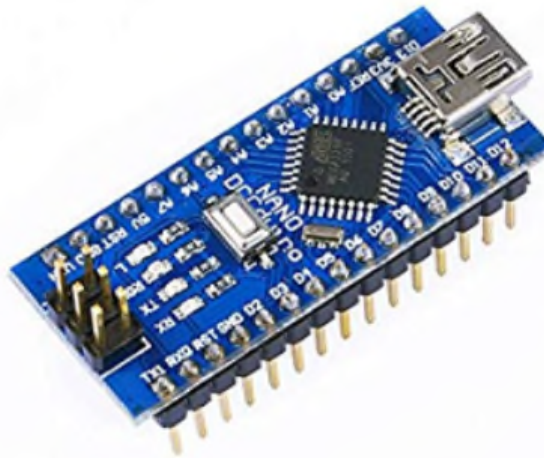
Gambar 2.1. Bentuk fisik modul Arduino Nano ( www.theengineeringprojects.com )
