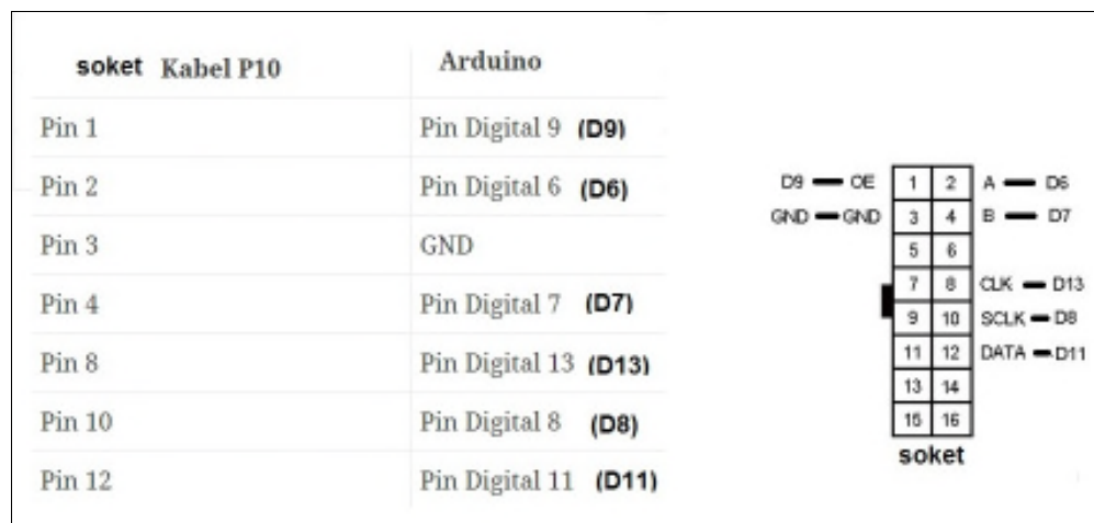
Gambar 2.5. Koneksi pin-pin Arduino dengan pin-pin DMD P10 ( https://pccontrol.wordpress.com/2016/04/30/pengetahuan-dasar-pemrograman-modul-leddot-matrik-display-dmd-p10-dengan-arduino/ )
