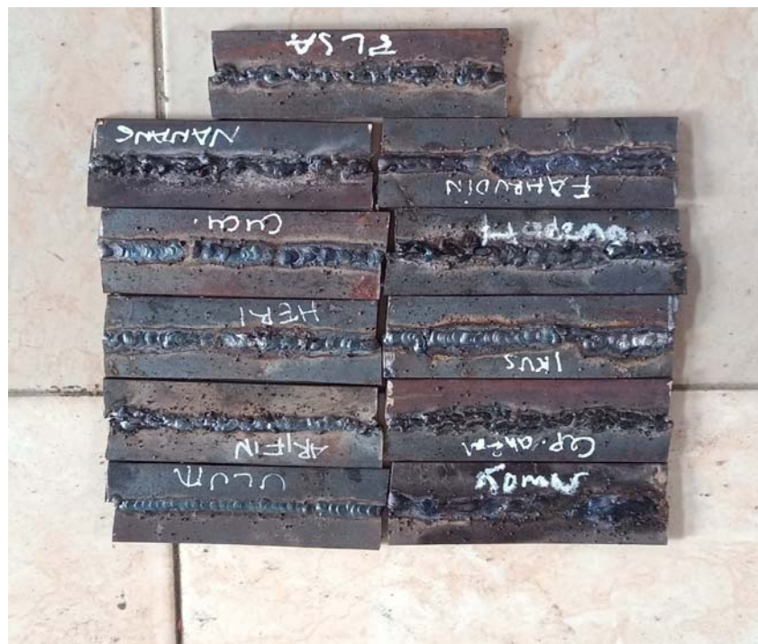
Gambar 7. Hasil Pengelasan para peserta pada pengelasan plat dan siku
