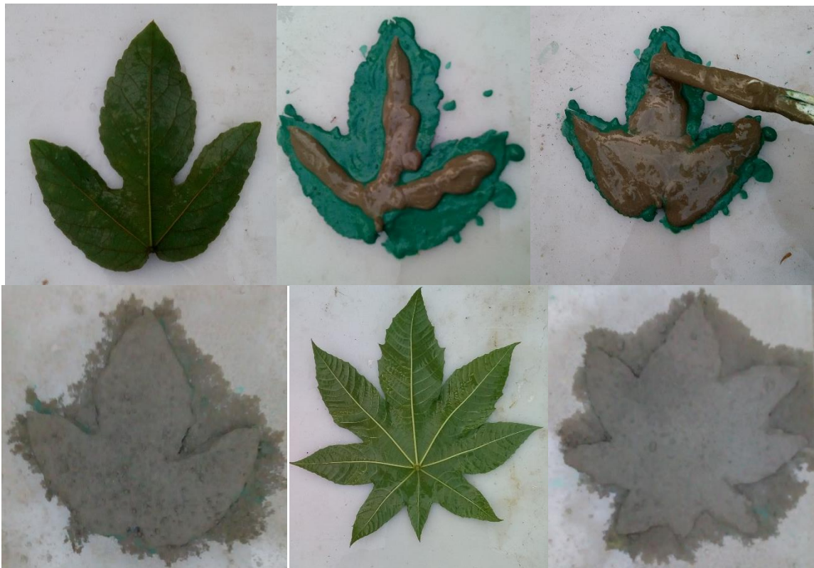
Gb.6. Proses pembuatan cetakan menggunakan satu lembar daun kecil. (Sumber: Pribadi)
