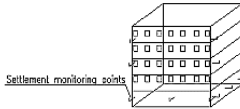
Gambar 143 Skema pemasangan titik monitoring pada struktur Gedung
