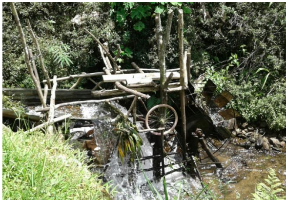
Gambar 1.3. Kincir Air Untuk Pembangkit Listrik Warga Cibodas
