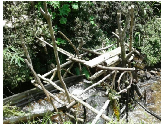
Gambar 1.3. Kincir Air Untuk Pembangkit Listrik Warga Cibodas
