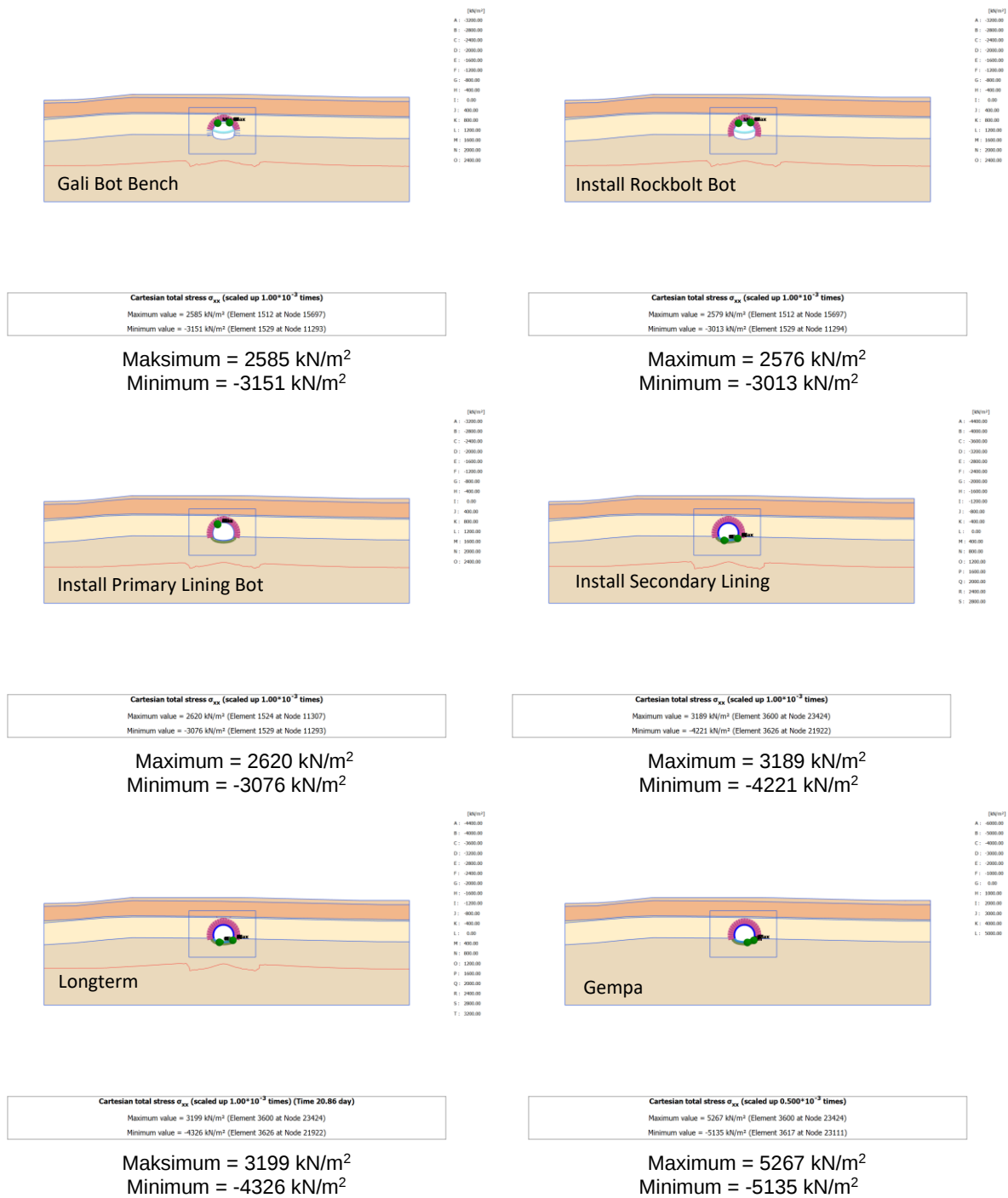
Gambar 72 Hasil analisis tegangan horizontal ( \sigma_x ) pada Tunnel Walini (DK 95+993) (lanjutan)
