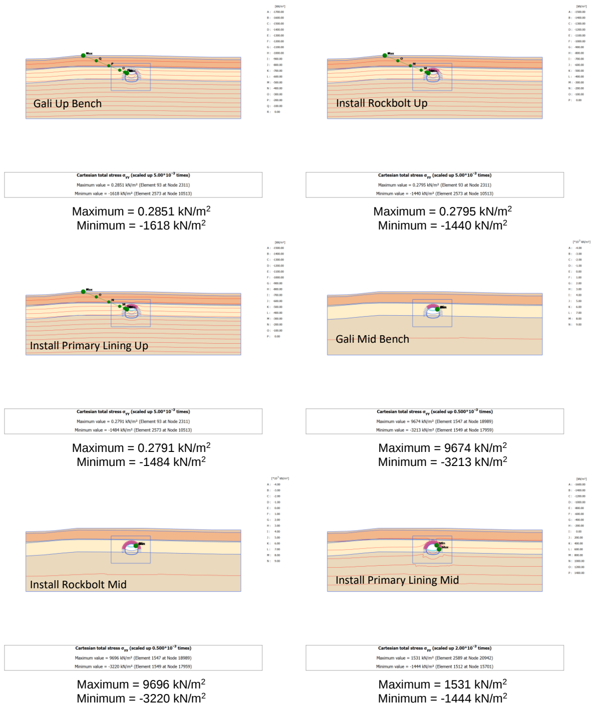
Gambar 73 Hasil analisis tegangan vertikal ( \sigma_y ) pada Tunnel Walini (DK 95+993)
