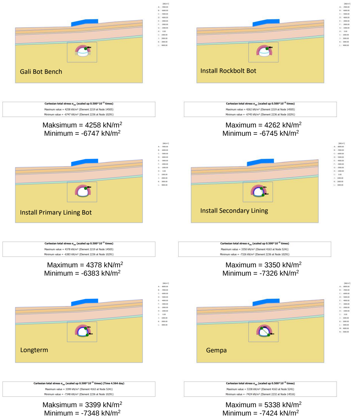
Gambar 42 Hasil analisis tegangan horizontal ( \sigma_x ) pada Tunnel Walini (DK 95+602) (lanjutan)
