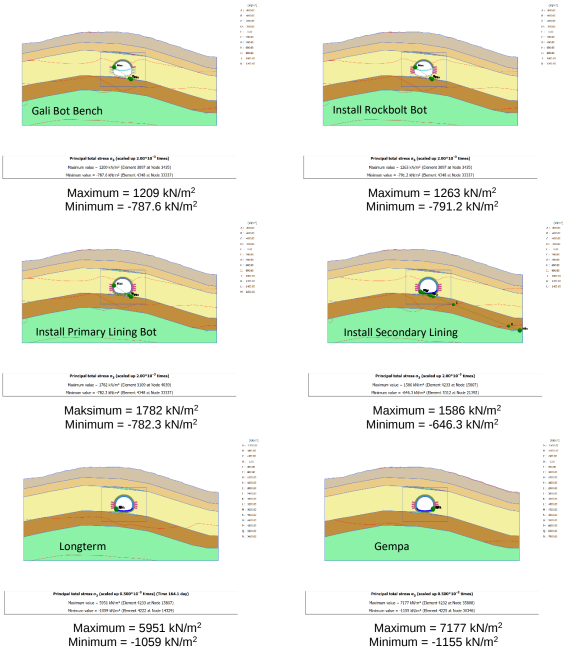
Gambar 49 Hasil analisis tegangan minimum ( \sigma_3 ) pada Tunnel No.5 (DK 86+890) (lanjutan)
