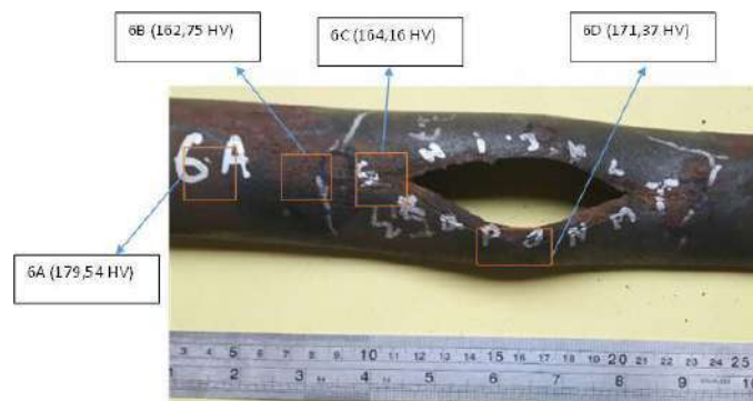
Gambar 13. Lokasi sampel struktur mikro dan harga kekerasan tube nomor 6.
