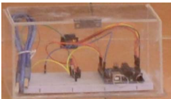
Gambar 13. Alat Pendeteksi Gempa Sederhana dengan sistem Arduino
