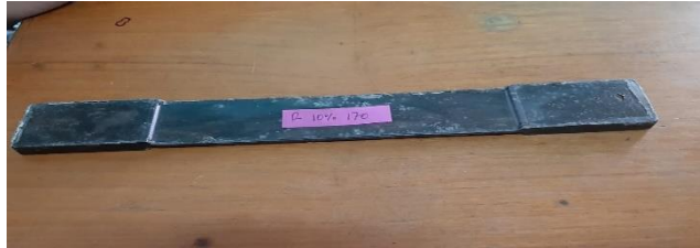
Gambar 5. Spesimen uji tarik komposit PPHI yang diperkuat serat alam
