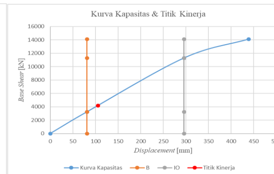
Gambar 12. Kurva Kapasitas dan Kinerja Struktur Pracetak dengan Base Isolator Arah UY
