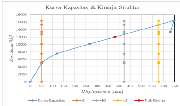
Gambar 5. Kurva Kapasitas dan Kinerja Struktur Cast in Situ tanpa Base Isolator Arah UX
