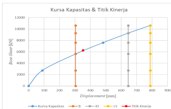
Gambar 9. Kurva Kapasitas dan Kinerja Struktur Cast in Situ dengan Base Isolator Arah UX
