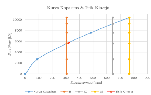
Gambar 11. Kurva Kapasitas dan Kinerja Struktur Pracetak dengan Base Isolator Arah UX
