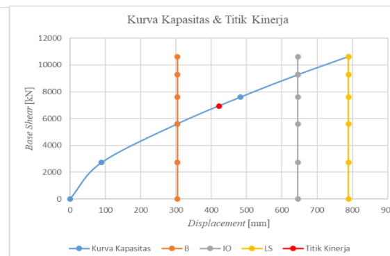
Gambar 10. Kurva Kapasitas dan Kinerja Struktur Cast in Situ dengan Base Isolator Arah UY
