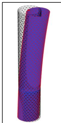
Gambar 3. Suction pile mengalami defleksi akibat beban lateral
