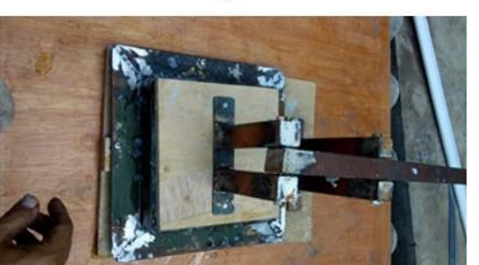
(f) Penutupan pulp dengan mesin press
