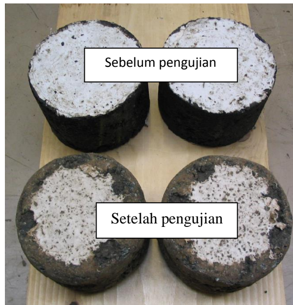
Gambar 43 Contoh benda uji sebelum dan setelah pengujian Cantabro
