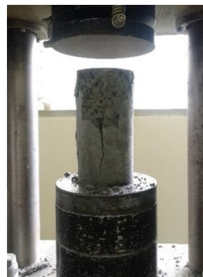
Gambar 3. Pola runtuh tekan uji mendekati hasil tekan prediksi
