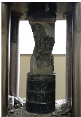
Gambar 2. Pola runtuh tekan uji yang lebih rendah dari hasil tekan prediksi
