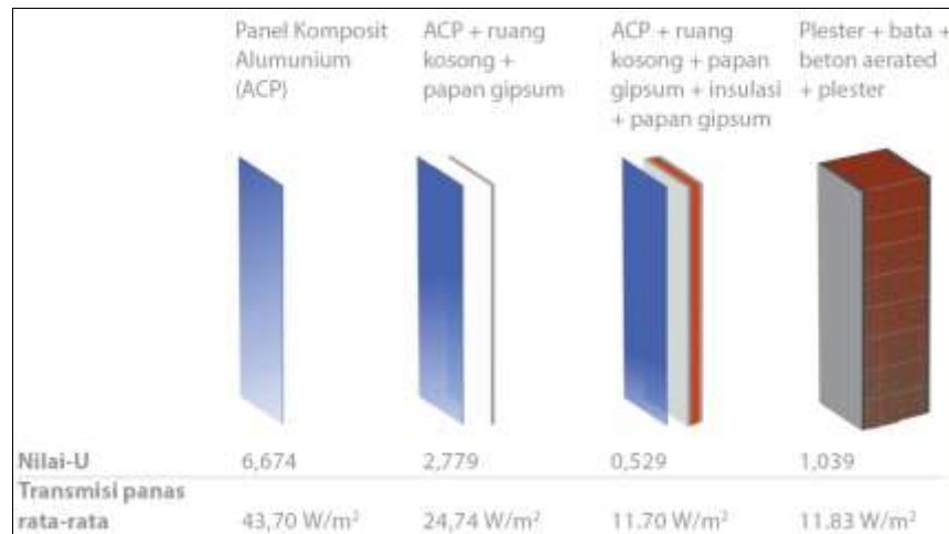
Gambar 2-7 Perbandingan transmisi panas berbagai komposisi material dinding
