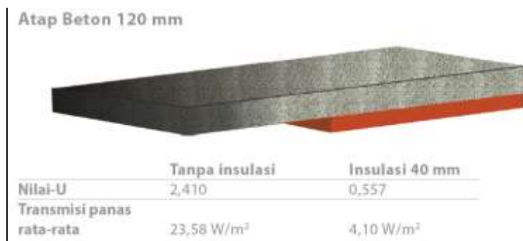
Gambar 2-10 Perbandingan transmisi panas rata-rata dari atap beton, tanpa dan dengan tambahan lapisan insulasi termal
