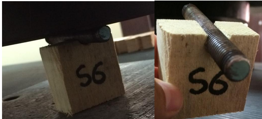
(a) (b) Gambar 4. (a) benda Uji saat diberikan beban; (b) kondisi kondisi benda uji setelah pengujian
