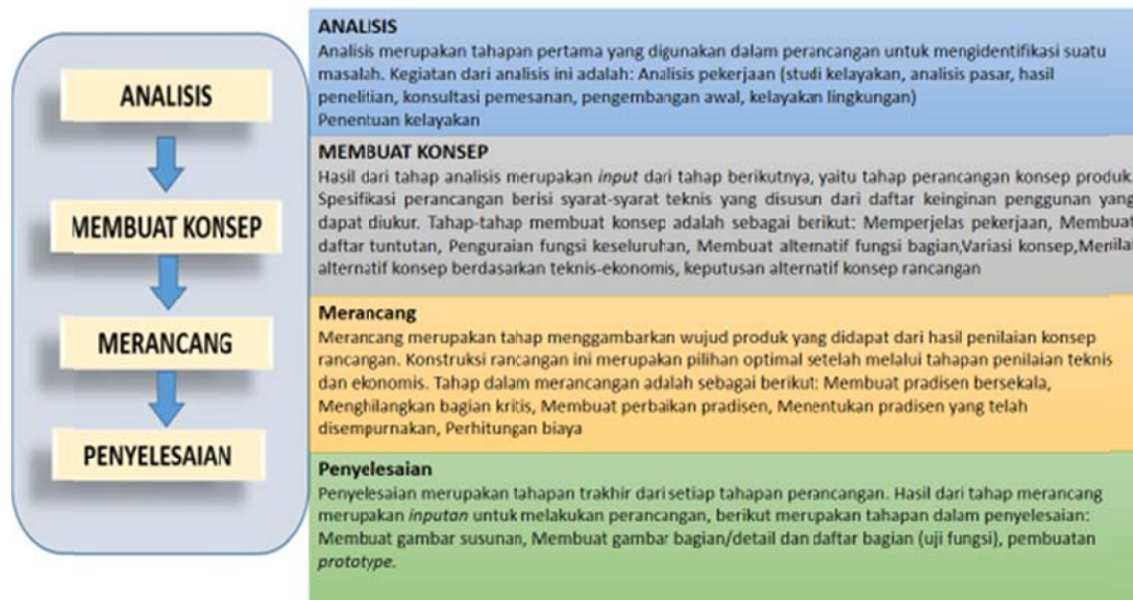
Gambar 2 Tahap-tahap perancangan yang dilakukan metode VDI 2222
