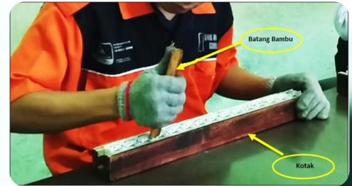
Kondisi Penekukan Menggunakan Bambu
